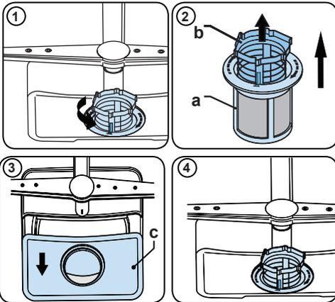
Para retirar y limpiar el filtro combinado, gírelo en sentido antihorario y sáquelo elevándolo hacia arriba (1). Extraiga el filtro grueso del microfiltro (2). Luego extraiga y retire el filtro de metal (3). Aclare el filtro con mucha agua hasta que quede sin residuos. Rearme los filtros. Sustituya el
